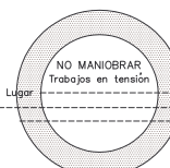
NO MANIOBRAR TRABAJOS EN TENSION
